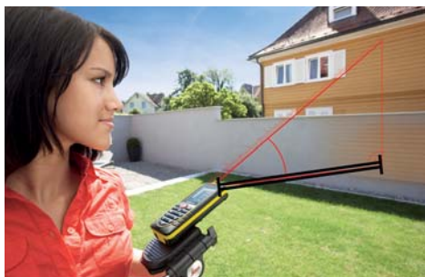
Wyznacz odległość poziomą mimo przeszkód na danym odcinku. Umożliwi to czujnik pochylenia.
