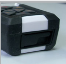
Odchylana igła, umożliwiającą pomiar od wewnętrznej strony narożników.
